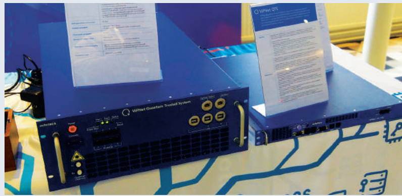
▲ Рис. 6. Слева – блок, содержащий магистральный узел квантовой сети (с приемником и передатчиком фотонов) и распределительный узел для ветвления сети. Справа – классический криптошлюз
