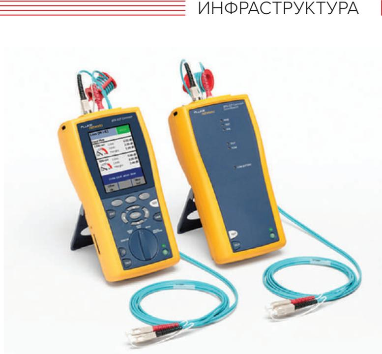
▲ Рис. 2. Прибор DTX-1800 с подключенными оптическими модулями DTX-MFM и многомодовыми шнурами с катушками-оправками
