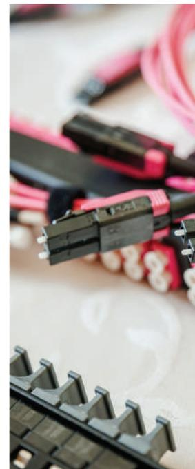
пы VSFF с вертикальным дизайном. Последние ориентированы на схему Base8 и легко решают проблему полярности формируемых трактов, упрощают агрегацию каналов и построение отказоустойчивых структур, а также способствуют снижению потерь в тракте за счет уменьшения количества точек срачивания.
