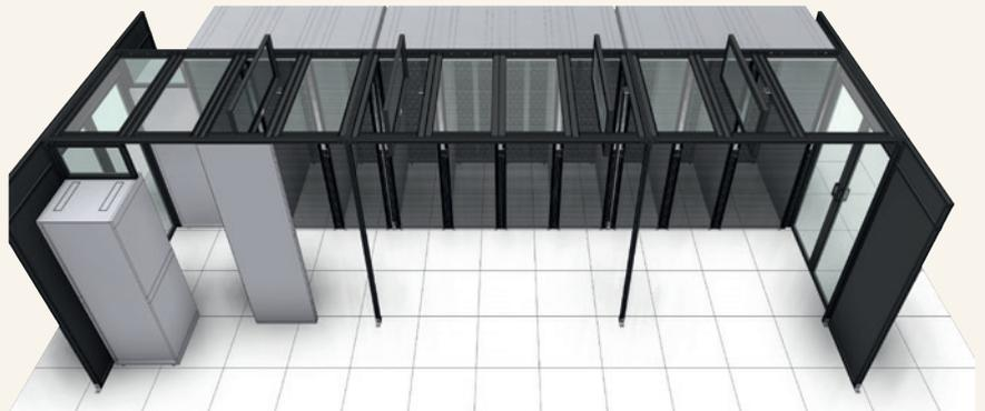
Система изоляции коридоров ART Engineering – это пассивная система охлаждения, которая физически отделяет поток холодного приточного воздуха от горячего отработанного воздуха, поступающего от ИТ-оборудования. Коридоры могут быть как горячими, так и холодными.
