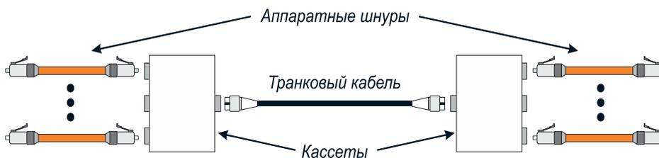
◀ Рис. 4. Схема простого модульно-кассетного тракта с дуплексным пользовательским интерфейсом
